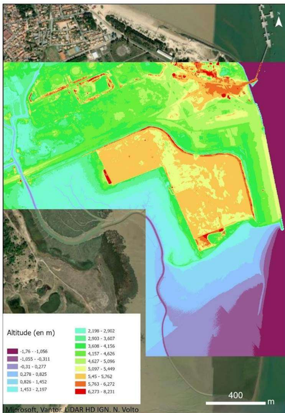
Figure 4. Modèle numérique de terrain montrant les altitudes dans la zone projet (m NGF, Lidar IGN 2023).
